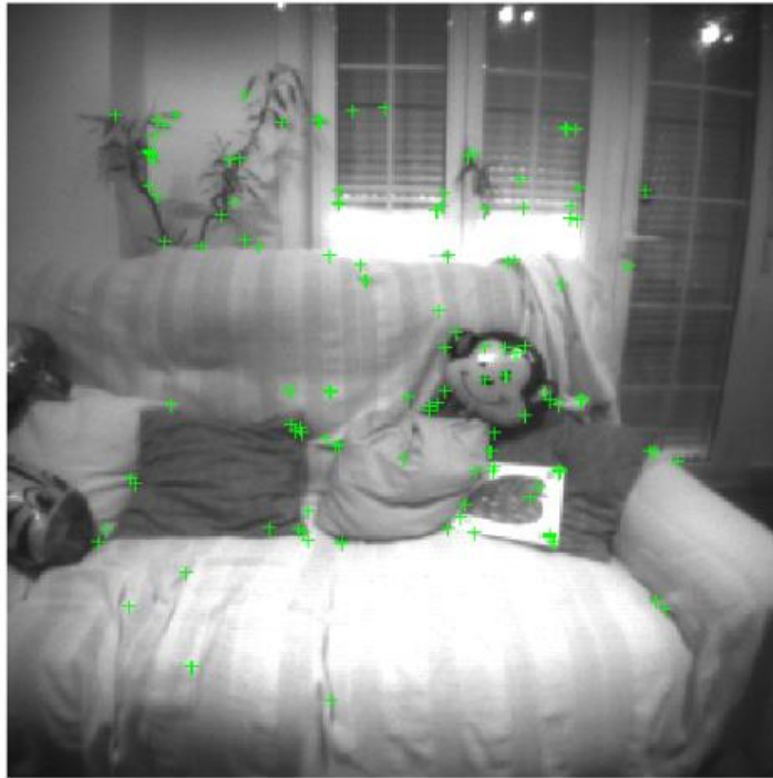
Figura 51. Imagen 2 con los puntos ORB obtenidos en el emparejamiento que existen en el mapa 3D.
