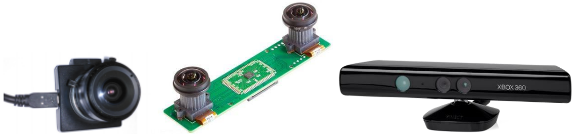
Figura 4. Diferentes ejemplos de cámaras para SLAM visual. A la derecha una cámara monocular, en el centro una cámara estéreo [4], y a la derecha una cámara RGB-D [5].
