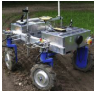
Figura 1.1: Vehículo autónomo para detección de hiervas, imagen extraída de Bechar and Vigneault [2016]
