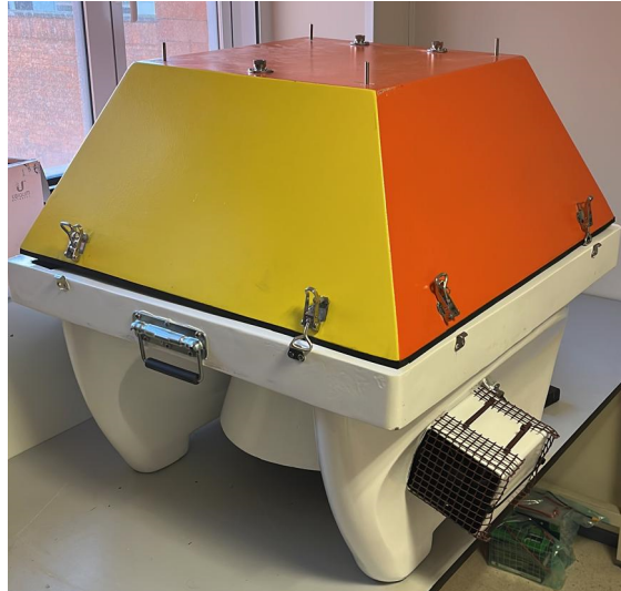
Figura 1.3: Vehículo de superficie Boyi para detección de concentraciones de cianobacterias desarrollado por ISCAR
