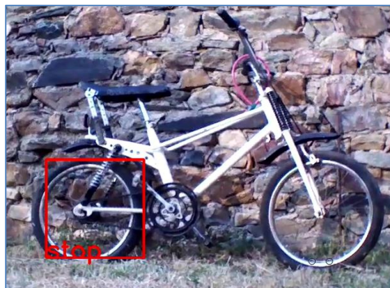
Figura 57. Detección de falso positivo en la prueba 7.
