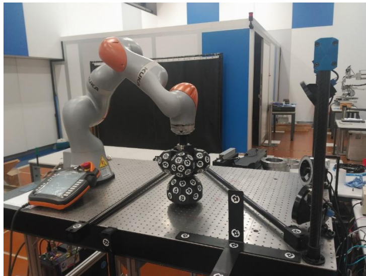
Figura 13. Calibración del sistema mediante fotogrametría
