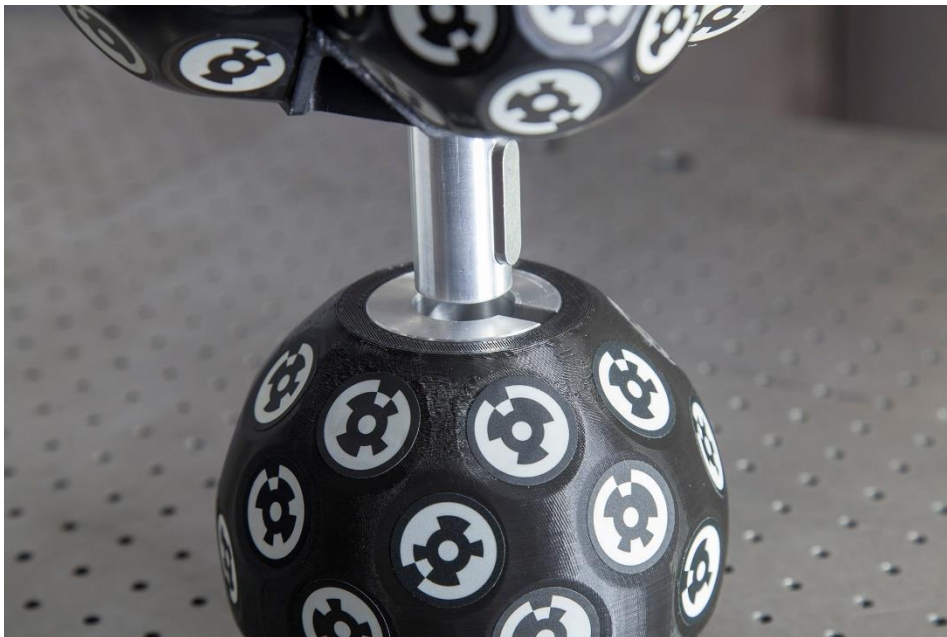
Figura 12. La herramienta del robot entrando en el objeto base
