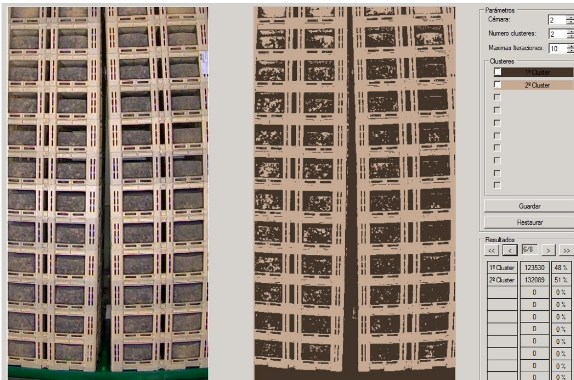
5-5 Resultado de imagen con nivel alto de moho de la fase aprendizaje mediante algoritmo Fuzzy K-means en 2 clusters
