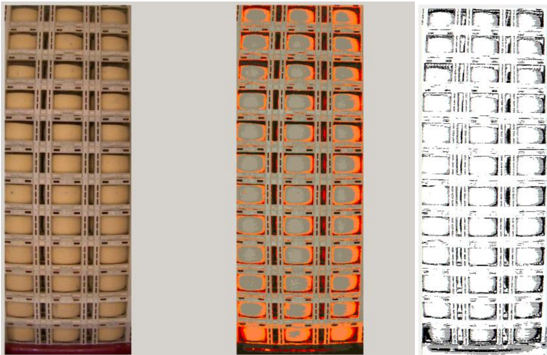
5-30 Resultados del método Fuzzy k-means y método Otsu en el palé número 4.
