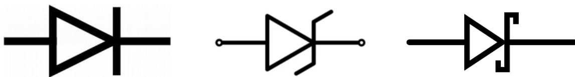
Figura 9. Símbolo de componente (de izquierda a derecha): normal, Zener, Schottky (Fuente: elaboración propia)
