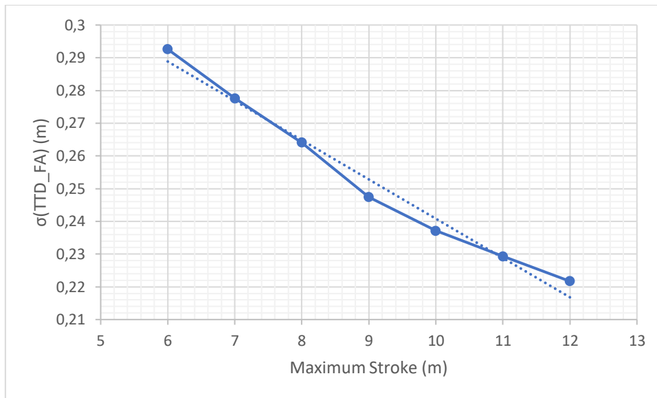
Figura 3.7.- Relación de prestaciones de un TMD con su recorrido permitido
