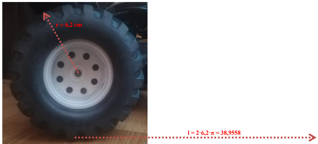
Figura 53 - Relación entre el radio de la rueda y el arco recorrido en una vuelta
