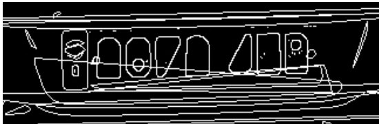
Imagen 54: Imagen resultante de aplicar la función convexHull para obtener la curva convexa
