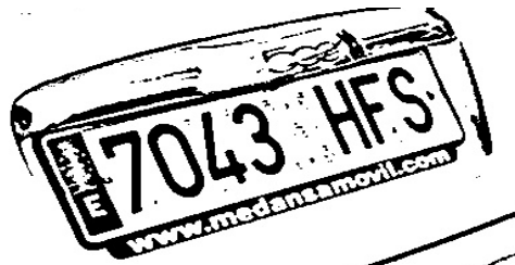
Figura 40: Imagen resultante de aplicar un umbral adaptativo con tamaño de bloque de vecinos de 31, un C de 7 y función de umbral gaussiana
