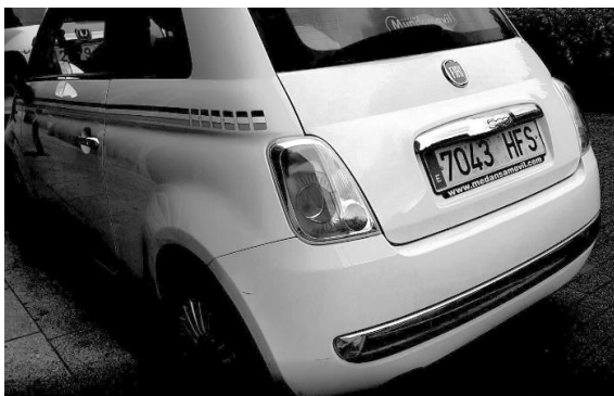
Figura 6: Imagen obtenida después de aplicar una ecualización del histograma de la imagen
