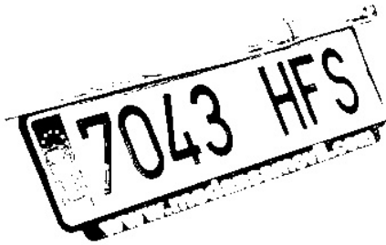
Figura 34: Imagen resultante de aplicar una umbralización mediante el algoritmo del Triángulo
