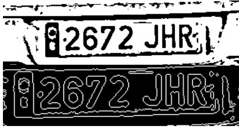
Figura 44: Imagen resultante de aplicar un umbral adaptativo con tamaño de bloque de vecinos de 21, un C de 7 y función de umbral gaussiana
