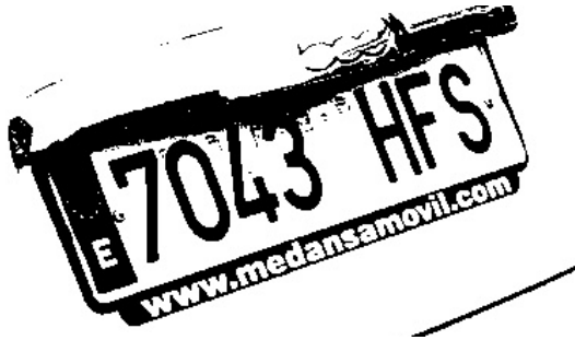
Figura 35: Imagen resultante de aplicar una umbralización mediante el algoritmo de Otsu
