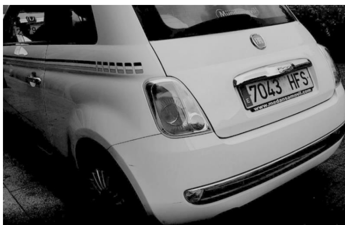
Figura 9: Imagen resultado de aplicación de la función blur con tamaño de matriz de 3x3
