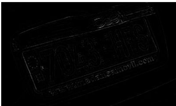
Figura 29: Imagen resultante de aplicar una transformación morfológica de tipo TopHat
