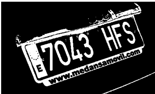
Figura 33: Imagen resultante de aplicar una umbralización inversa con umbral 100 y maxValor 255
