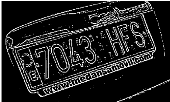
Figura 41: Imagen resultante de aplicar un umbral adaptativo binario inverso con tamaño de bloque de vecinos de 3, un C de 7 y función de umbral promedio
