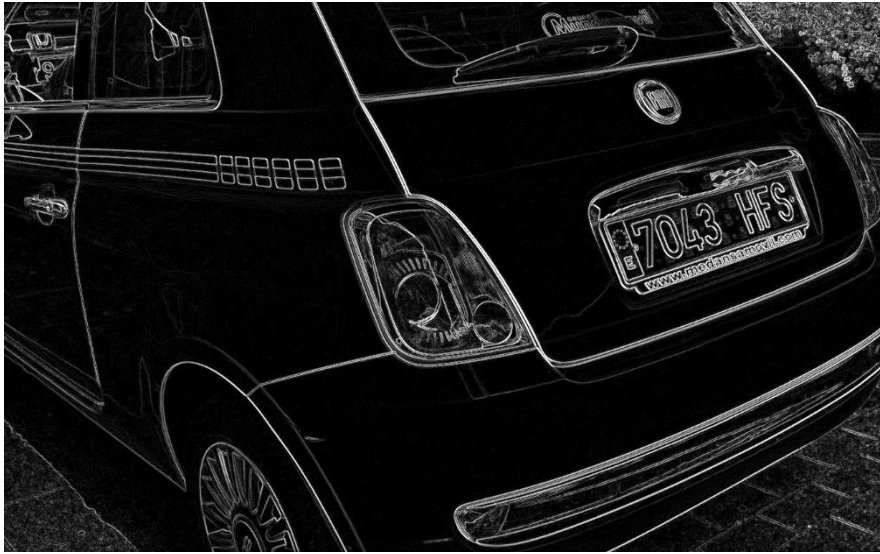
Figura 19: Imagen resultante de aplicar el algoritmo Sobel con orden de derivada 1
