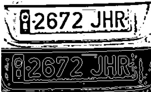
Imagen 45: Imagen resultante de aplicar un umbral adaptativo con tamaño de bloque de vecinos de 31, un C de 7 y función de umbral gaussiana
