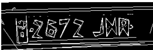
Figura 52: Imagen resultante de aplicar una aproximación poligonal con precisión de un 5% de la longitud del contorno
