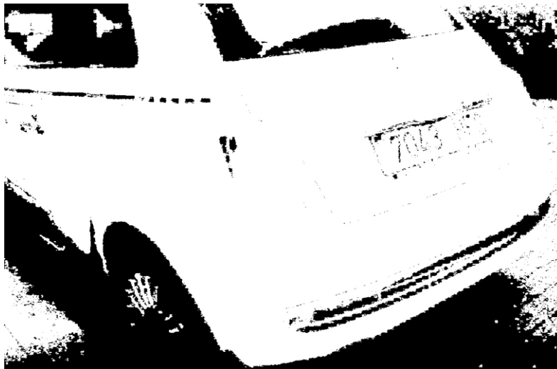
Figura 13: Imagen resultante de aplicar un filtro mediante una máscara de realce de bordes
