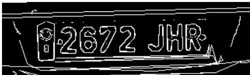
Figura 53: Imagen resultante de aplicar una aproximación poligonal con precisión de un 1% de la longitud del contorno
