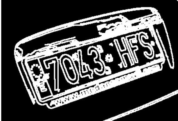
Figura 28: Imagen resultante de aplicar una transformación morfológica de tipo Cross después de haber aplicado un Canny
