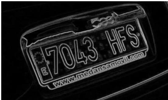
Figura 27: Imagen resultante de aplicar una transformación morfológica de tipo Gradiente
