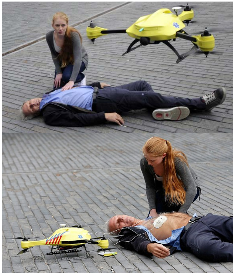
Figura 1-4 Proyecto de un UAV ambulancia desarrollado en la universidad TU Delft para el envío urgente de un desfibrilador [18].
