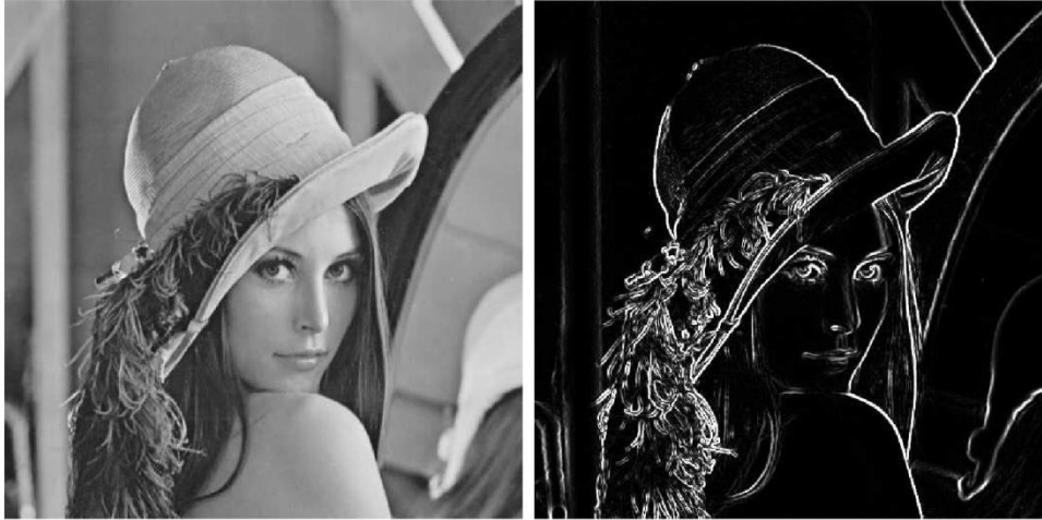
Figura 7.- Ejemplo de aplicación del operador de Sobel.
