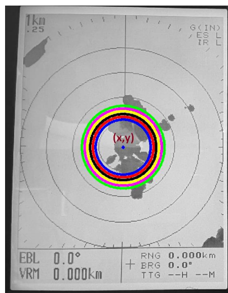
Figura 13.- Ejemplo de barrido de radios en la imagen de radar a partir de un centro (x,y) .
