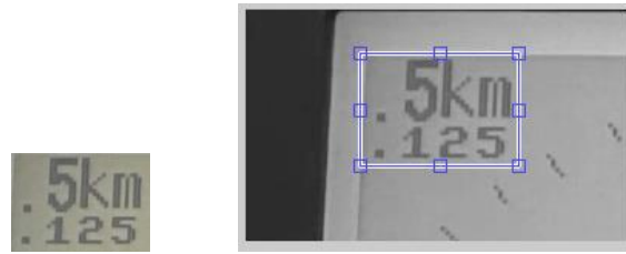
Figura 37.- Patrón a detectar (izquierda) y resultado de detección (derecha).
