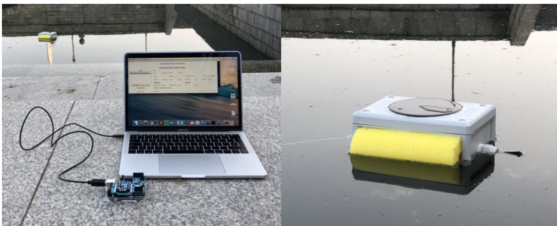
FIGURA 4-7. ESTACIÓN BASE (IZQUIERDA) Y SENSOR FLOTANTE (DERECHA).
