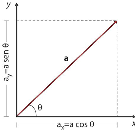
Si conocemos  $a_x$  y  $a_y$ , el ángulo  $\theta$  se obtiene mediante esta relación trigonométrica:
