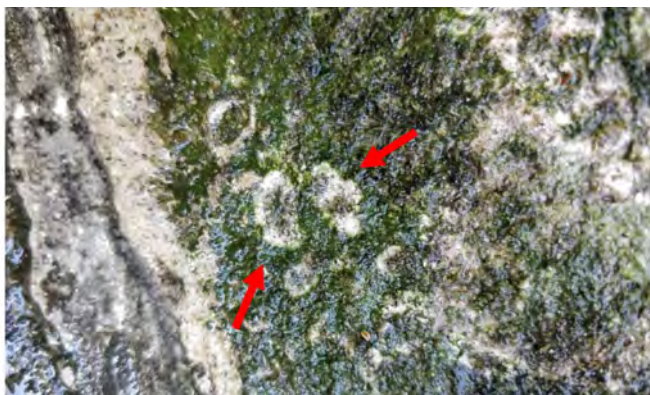
Figura 4. Halos de inhibición en la biopátina presente en el Pilar de Carlos V (monumento de la Alhambra).
