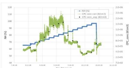
**Figura 2.** Concentración partículas respecto al tiempo en función del promedio de potencia motor 50. Muestreo representativo
