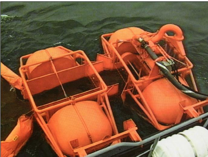
**Figura 1-Aspirador Flotante Controlado (AFC) fabricado por la empresa Novetec para la limpieza de petróleo en alta mar.**
