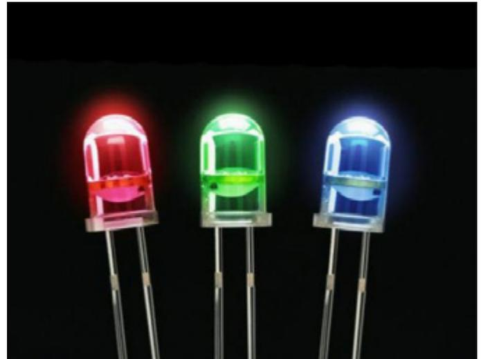
LEDs de diferentes longitudes de onda
