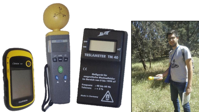
Figura 5. (Izda.): Aparatos utilizados para realizar las mediciones; de izquierda a derecha se muestran GPS GARMIN, medidor PCE-EM 29 provisto de sonda isotrópica y Teslámetro TM 40. (Dcha.): Realizando mediciones con medidor de radiofrecuencias PCE-EM 29. (Foto: José M. Caballero).
