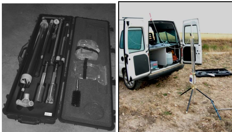
Figura 2. Permeámetro de Guelph y ensayo de campo.
