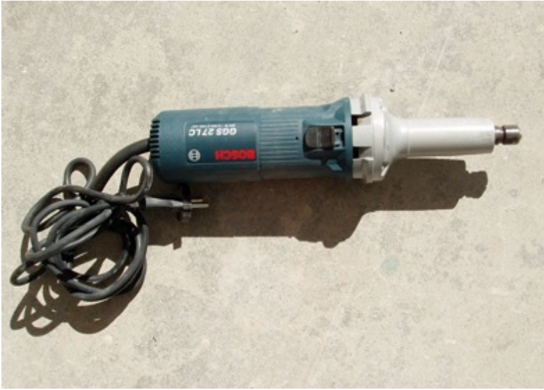
Amoladora recta o fresadora. Arriba eléctrica, abajo neumática. Diversos útiles: Fresas, lijas y limas
