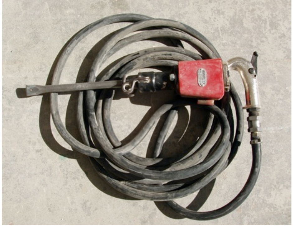
Martillo neumático demoledor.
