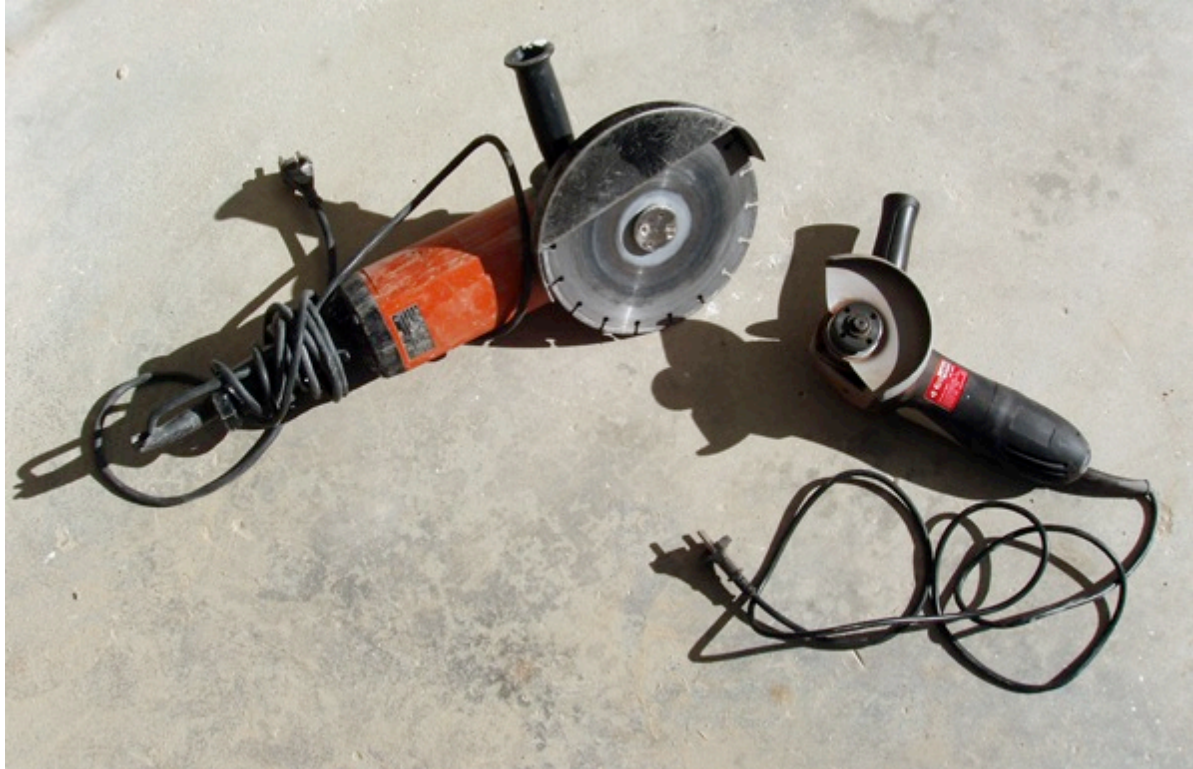
Radial o amoladora angular grande con disco de diamante y radial pequeña.
