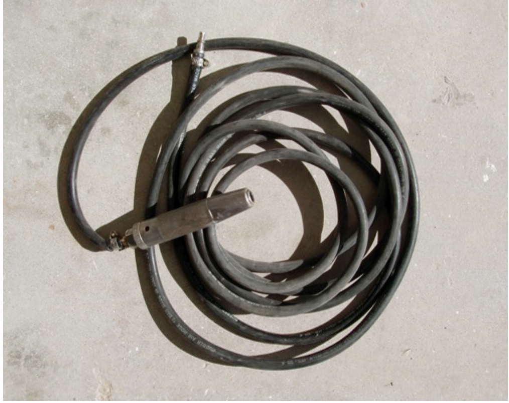
Martillo neumático para herramientas de talla en piedra.
