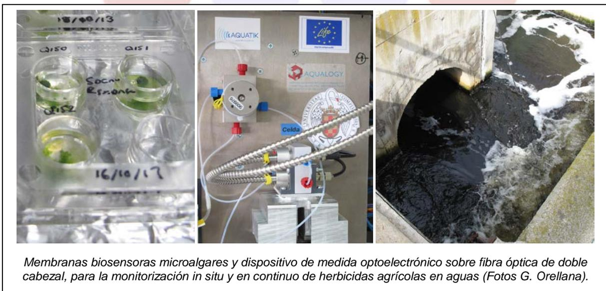
*Membranas biosensoras microalgares y dispositivo de medida optoelectrónico sobre fibra óptica de doble cabezal, para la monitorización in situ y en continuo de herbicidas agrícolas en aguas (Fotos G. Orellana).*
