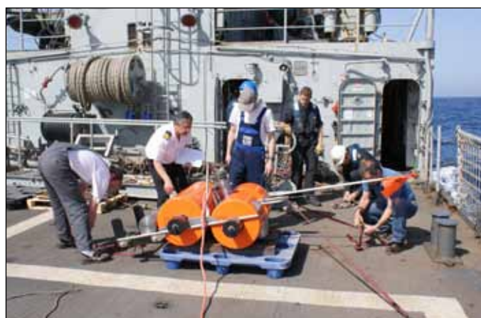
Figura 4.- Instalación de un OBS de la red FOMAR llevada a cabo por ROA y la Armada Española (patrullero "VIGIA")
