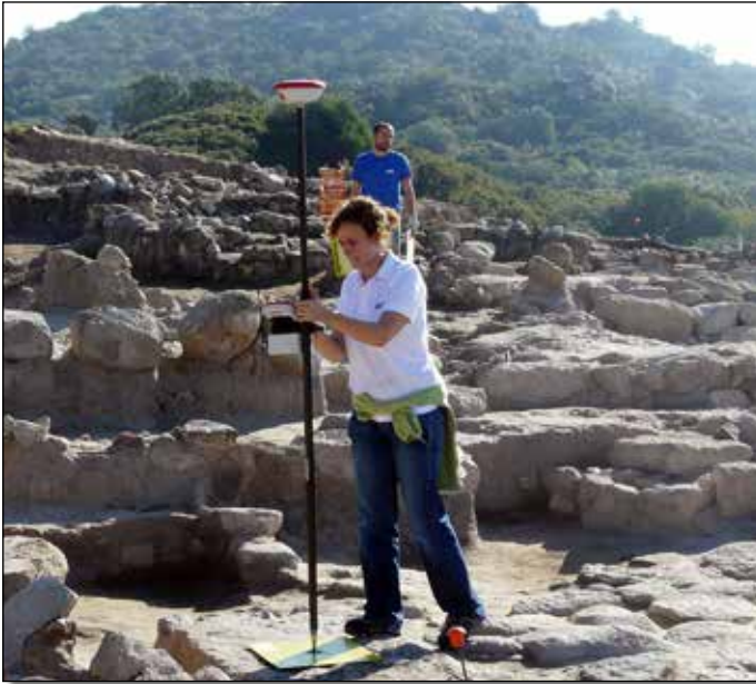
Empleo del DGPS para referenciar la ortofotografía
