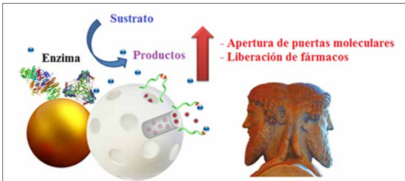
Figura 4.- Sistemas inteligentes de sensorización y liberación controlada basados en nanopartículas Janus.
