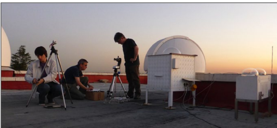
Investigadores preparando los instrumentos de campo para comparar con medidas de los monitores del Observatorio UCM. En primer plano, con cúpulas transparentes, los instrumentos AstMon-UCM y el espectrógrafo SAND.
