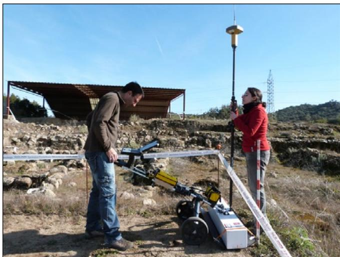
Antena de georradar de 600 MHz con referenciación GPS
