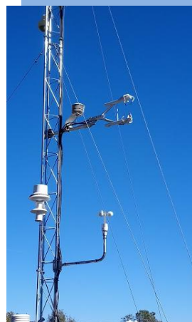
Sensores de medida en EG010-Herrería: termohigrómetro, IRGASON, termómetro y veleta.
