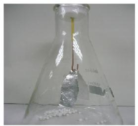
Figura 2. Electroscopio casero fabricado para el experimento
