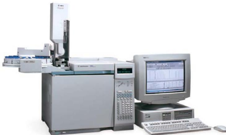
Cromatógrafo de gases. Agilent 6890N Network GC System
