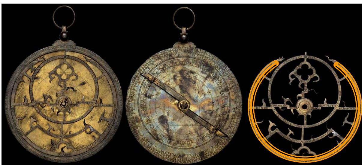
Fig. 4. Astrolabio con inscripciones en latín. Reino cristiano europeo, siglos, XIV-XV. Museo de Historia de la Ciencia de Oxford (nº inv. 47615). Cabeza y cola de dragón en la araña. Frente (izquierda), dorso (centro) y marcado de la posición virtual del cuerpo del dragón en el círculo de Capricornio (derecha).
