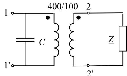
DATOS: Relación de transformación 400/100,  $Z = 32 + j24 \Omega$ ,  $f = 50 \text{ Hz}$ ,  $C = 2 \mu\text{F}$ .
