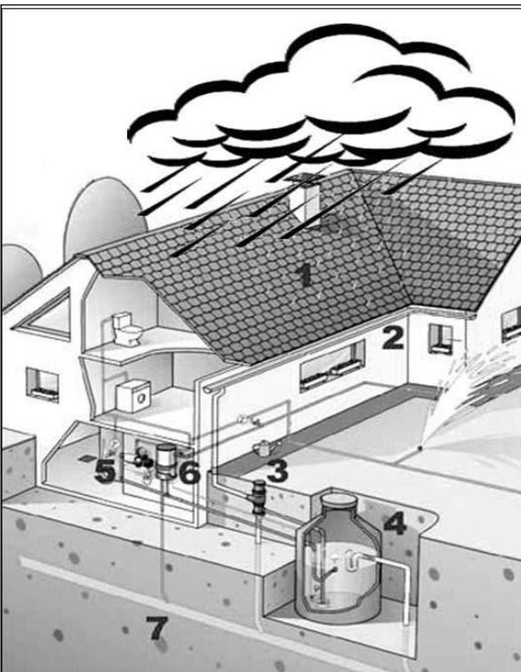
Esquema de instalación para la recogida de agua de lluvia a escala doméstica.
