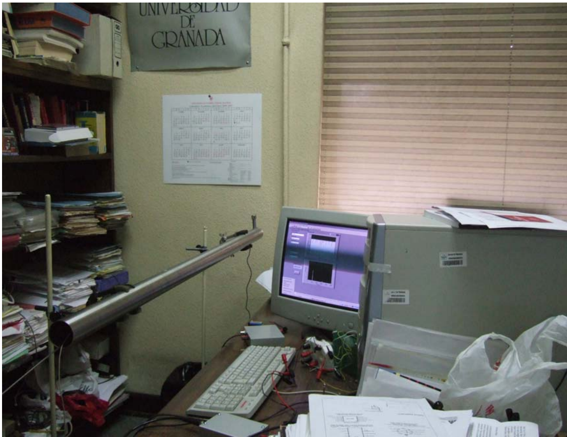
Tubo de Kundt para el estudio de propiedades termodinámicas de los gases, provisto de detección electrónica de las señales mediante una tarjeta de adquisición de datos y programas desarrollados en LabVIEW.
