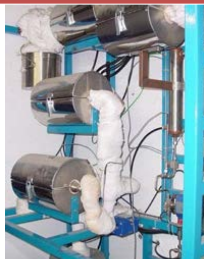
Reactor continuo que trabaja en condiciones supercríticas.
