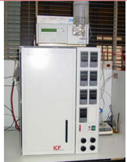
Reactor continuo en condiciones subcríticas con flujo descendente (TBR).
