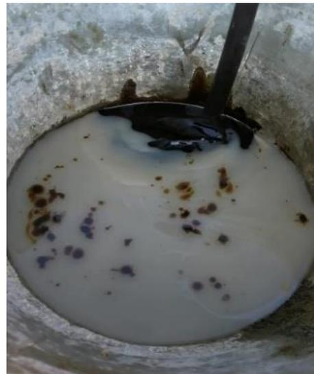
Ejemplo de extracción de fases orgánicas residuales del subsuelo tras extracción de una disolución del surfactante y posterior extracción
