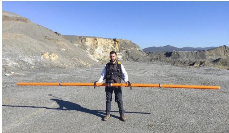
Sistema CMD-Explorer con los tres pares de antenas integradas y el GPS TOPCON, en trabajos de caracterización ambiental. Profundidad de penetración hasta 6,7 m.
