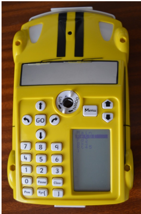
Figura 1. Imagen del robot programable Pro-Bot, en la que se muestran su teclado y su pantalla, con un procedimiento que dibuja los 8 radios de un octógono regular. Las teclas de la parte izquierda corresponden a la programación (las flechas en esta parte corresponden a avanzar y retroceder y a girar a la izquierda y a la derecha). Las flechas en la parte derecha permiten moverse por las líneas de código en el display LCD. Fuente: elaboración propia.
