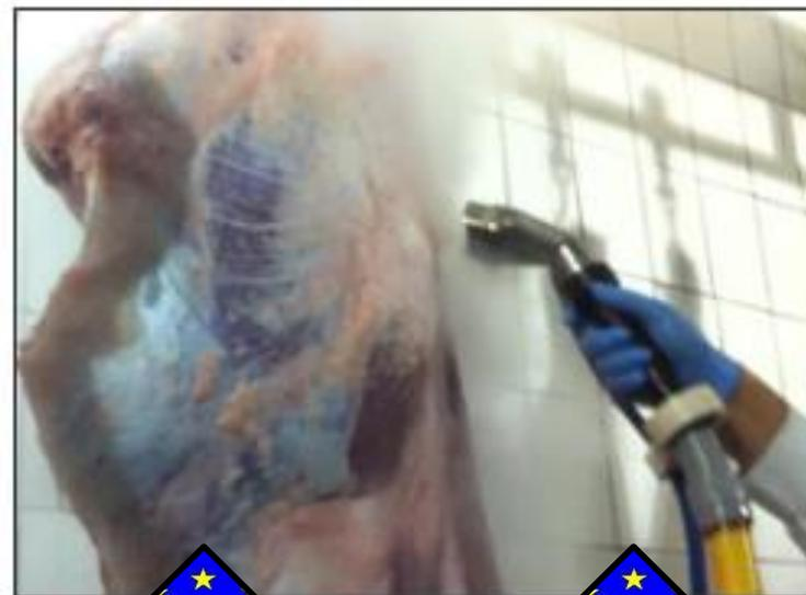
Intecal comercializa en España el equipo Vapo-Vac para la descontaminación de canales de vacuno, porcino y ovino. El equipo está diseñado para la reducción microbiológica mediante la administración de vapor en las canales, disminuyendo de este modo los aerobios y enterobacterias. La nueva maquinaria incrementa la productividad, ya que aumenta la durabilidad de la carne y disminuye las mermas por recortes de higienización.
