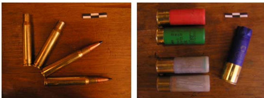
Ilustración 20 A la izquierda balas de rifle del 30.06, disparadas las dos de arriba y sin disparar las dos de abajo. (Foto del autor.) A la derecha cartuchos de escopeta. Rojo y verde: del 12, para caza menor; blancos: cartuchos de escopeta para Caza Mayor; azul: cartucho de caza menor disparado. (Foto del autor.)
