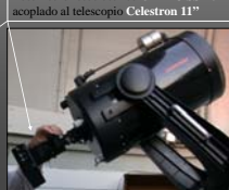
Fotómetro fotoeléctrico OPTEC SSP-3 acoplado al telescopio Celestron 11"
