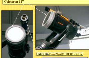
Filtros H \alpha (SolarMax40 + BF10) < 0.8 Å
