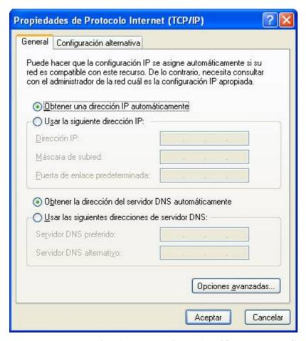
En esta ventana seleccionaremos la opción **Obtener una dirección IP** automáticamente y **Obtener la dirección del servidor DNS** automáticamente.
