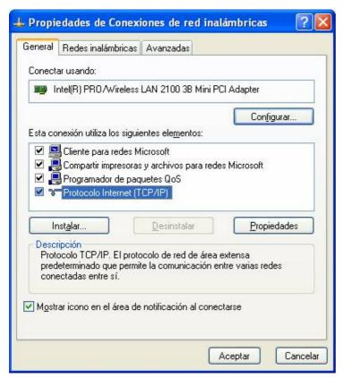
Colocamos el puntero del ratón sobre el protocolo TCP/IP y seleccionamos **Propiedades** para acceder a la siguiente ventana.
