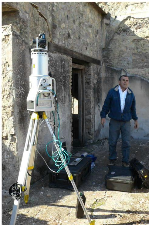
El escáner a la vez que registró puntos tomó fotografías de manera automática mediante una cámara convencional de alta definición, para ser empleadas en operaciones de post-proceso. Finalmente obtuvimos un registro completo y preciso de la citada casa que permitía apreciar con claridad su estructura y la disposición de sus diferentes elementos incluido el sótano.
