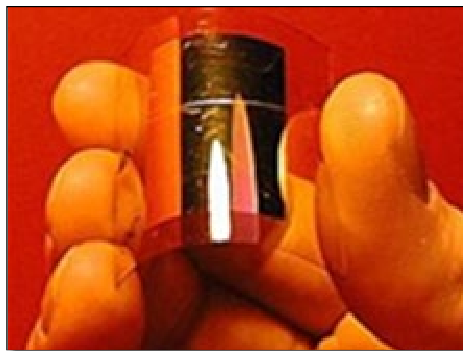
Figura 4. Célula fotovoltaica basada en fullereno C 60 que muestra la flexibilidad y ligereza propia de las células de naturaleza orgánica
