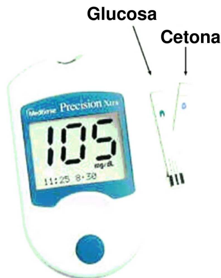
Fig. 3 Fotografía de un glucometer, biosensor sensible a glucosa y cetona ampliamente extendido en la monitorización de la glucemia.
