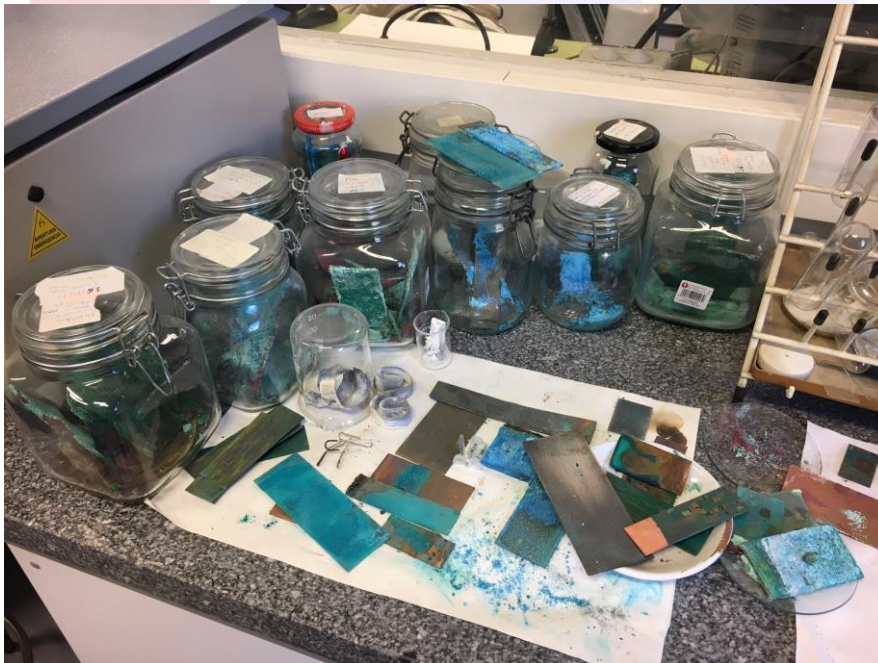
Ensayos de corrosión y de producción de pigmentos históricos en el laboratorio de materiales de la facultad de Bellas Artes. / UCM.
