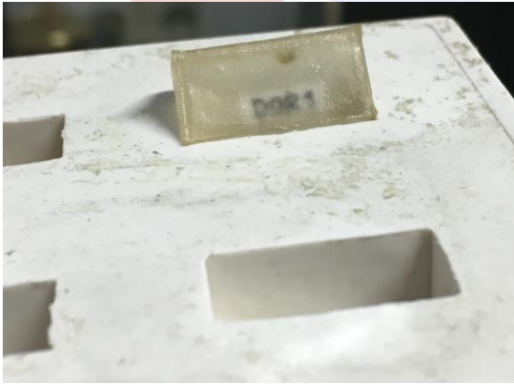
Una de las muestras del laboratorio incrustada en una resina y acompañada de su referencia. / UCM.
