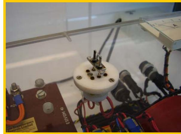
**Dispositivo de carga de la muestra en el filamento**
