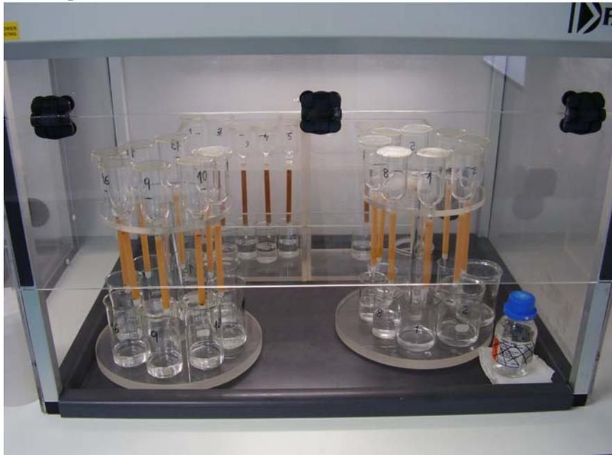
**Columnas cromatográficas para separación de Rb, Sr y REE**
