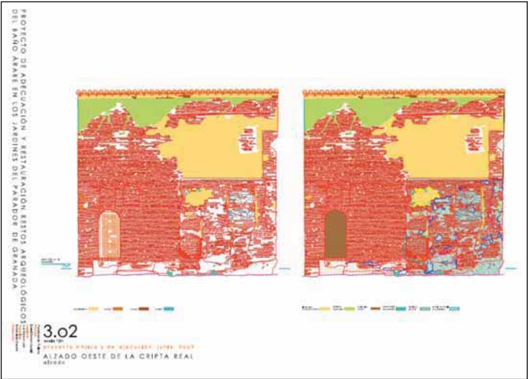
Figura 6. Alzado estratigráfico del frente de la cripta de los Reyes Católicos
