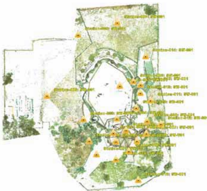
Figura 5. Posiciones del escáner en las tomas exteriores
