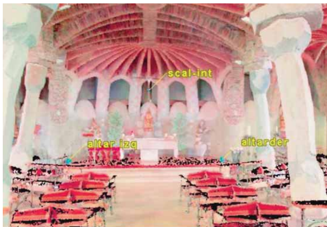
Figura 10. Nube de puntos tras texturización
