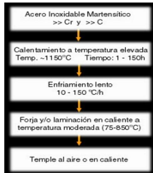
*Esquema del proceso de forja.*
