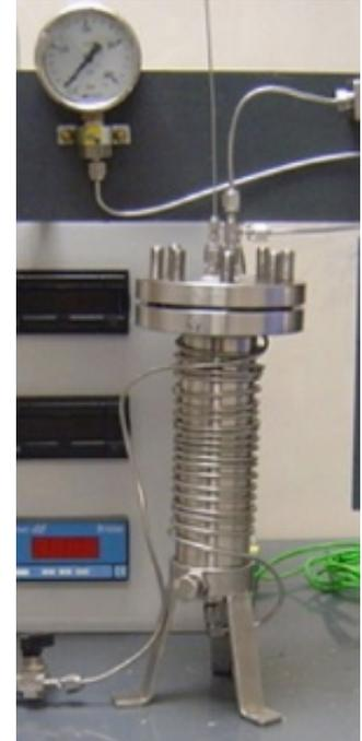
Imagen de un recipiente de esterilización con CO<sub>2</sub> supercrítico para productos sólidos de escala laboratorio.
