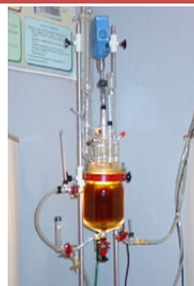
Reactor de laboratorio para producción de biodiesel.
